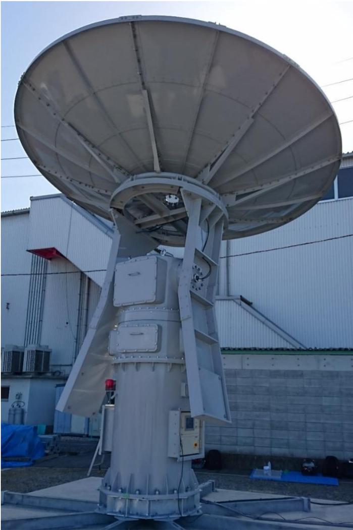
4.5 m  $\phi$  衛星追尾用回転装置
