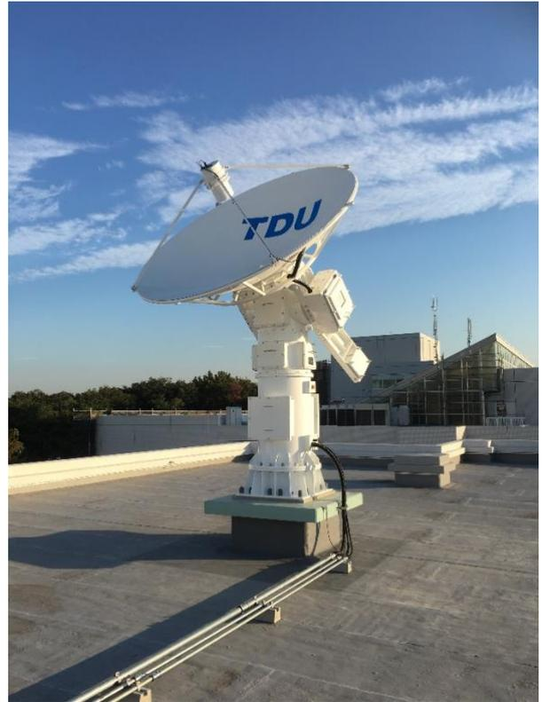
3.0 m  $\phi$  衛星追尾用回転装置
